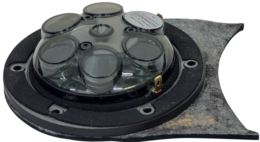
Il tweeter offre un gruppo magnetico davvero particolare, frazionato e costituito da 6 pasticche al neodimio la cui disposizione permette la formazione di un piccolo volume di caricamento che si intravede, riempito di materiale smorzante, attraverso la copertura semitrasparente.
