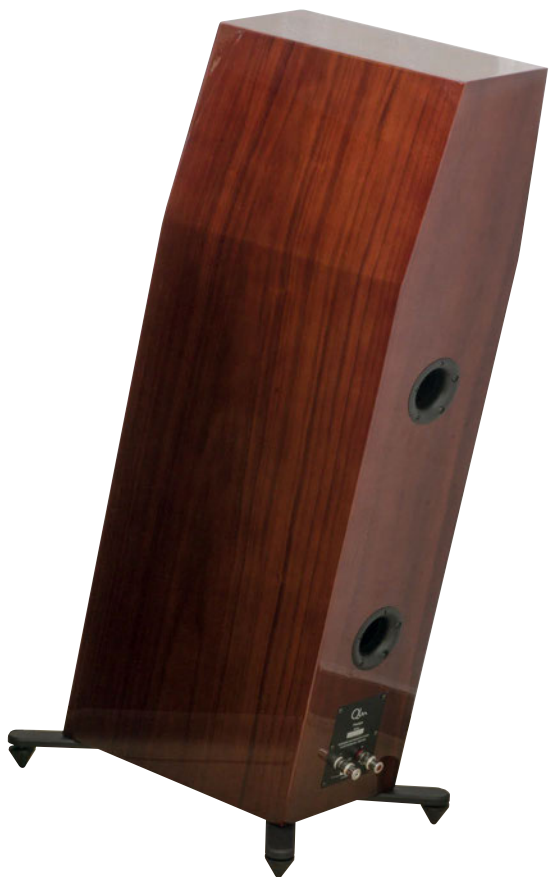
Il retro del diffusore mostra la presenza dei due condotti di accordo dal bordo smussato relativi ai volumi di caricamento di woofer e midwoofer. In basso i pregiati morsetti, singoli, di collegamento.
