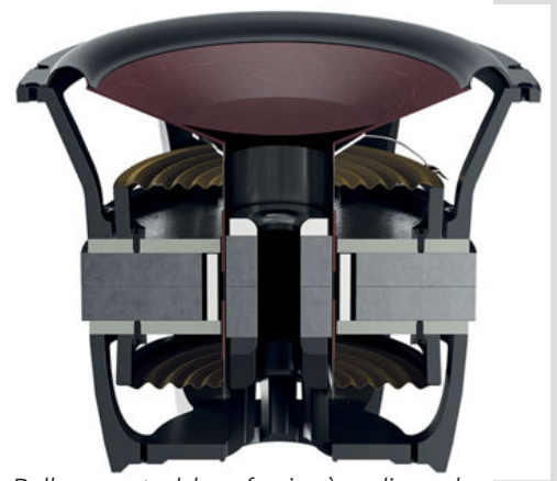
Dallo spaccato del woofer si può analizzare la struttura Balanced Drive SMC a due bobine.
