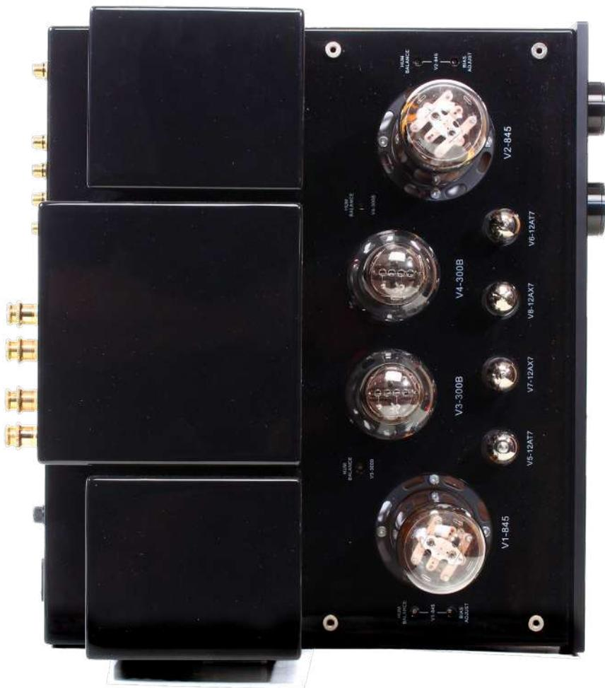
Le valvole di preamplificazione sono 12AX7 e 12AT7 cui seguono una replica della WE 300B prodotta da Psvane e una 845 marchiata Triode. A fianco delle valvole della sezione di potenza sono presenti i trimmer per la regolazione del bias e del ronzio.
