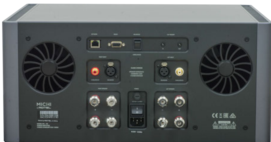
Sul retro dell'imponente finale S5 spiccano le due coppie di morsetti placcati in rodio (le due uscite sono in parallelo) e le feritoie dei condotti di raffreddamento.
