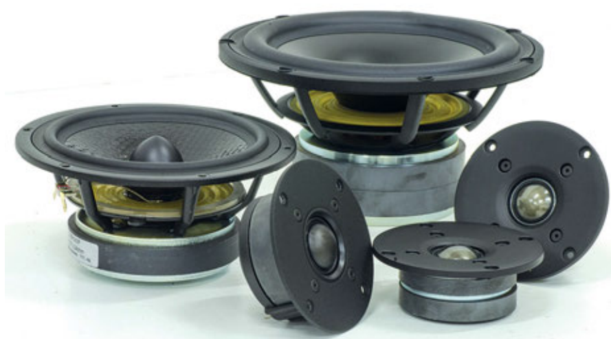
Gruppo di famiglia degli altoparlanti utilizzati. Notare la differenza tra i due tweeter posteriori, dotati di doppio anello di ferrite, ed il tweeter frontale che invece ha una doppia camera di decompressione posteriore.
