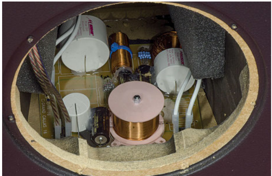
Alla base del diffusore è sistemato il filtro crossover. Notare la qualità dei componenti usati.
