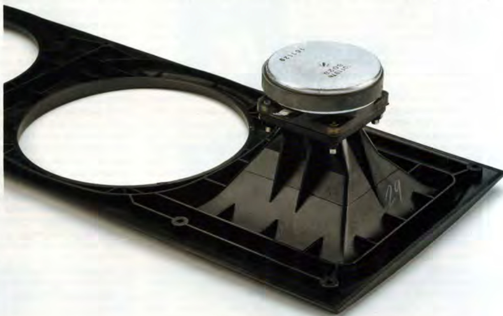
La tromba a profilo Tractrix che carica il tweeter è ricavata nel pannello frontale di copertura realizzato con un pvc particolarmente afono. Notare il complesso magnetico in ferrite.
