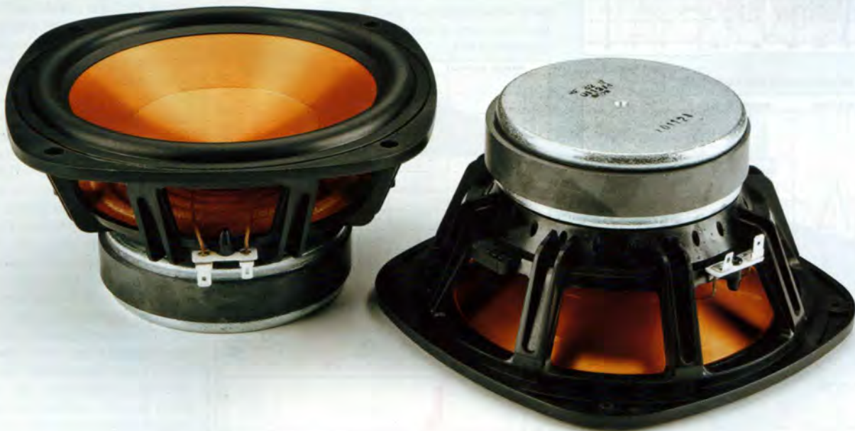
Il trasduttore per le note basse e medie. Si tratta di un upgrade del vecchio modello a cui è stato eliminato il doppio anello di ferrite a causa di un nuovo disegno delle terminazioni polari teso a diminuire la distorsione ed aumentare la sensibilità. Notare la membrana in Cerametallic e la cuffia parapolvere concava.
