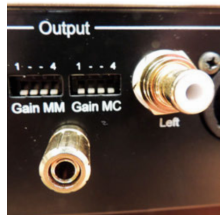
Il connettore per la messa a terra è posto vicino alle uscite, sotto i selettori di guadagno.
