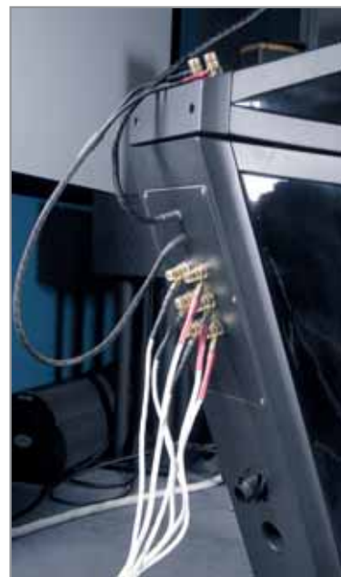
La morsettiera sul retro e il collegamento tri-wiring effettuato con i cavi White Gold Prestige M. Notare in basso le due uscite del reflex con l'accordatore in dotazione inserito nel foro superiore.
