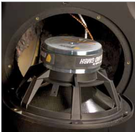
Il complesso magnetico del woofer Eton.
