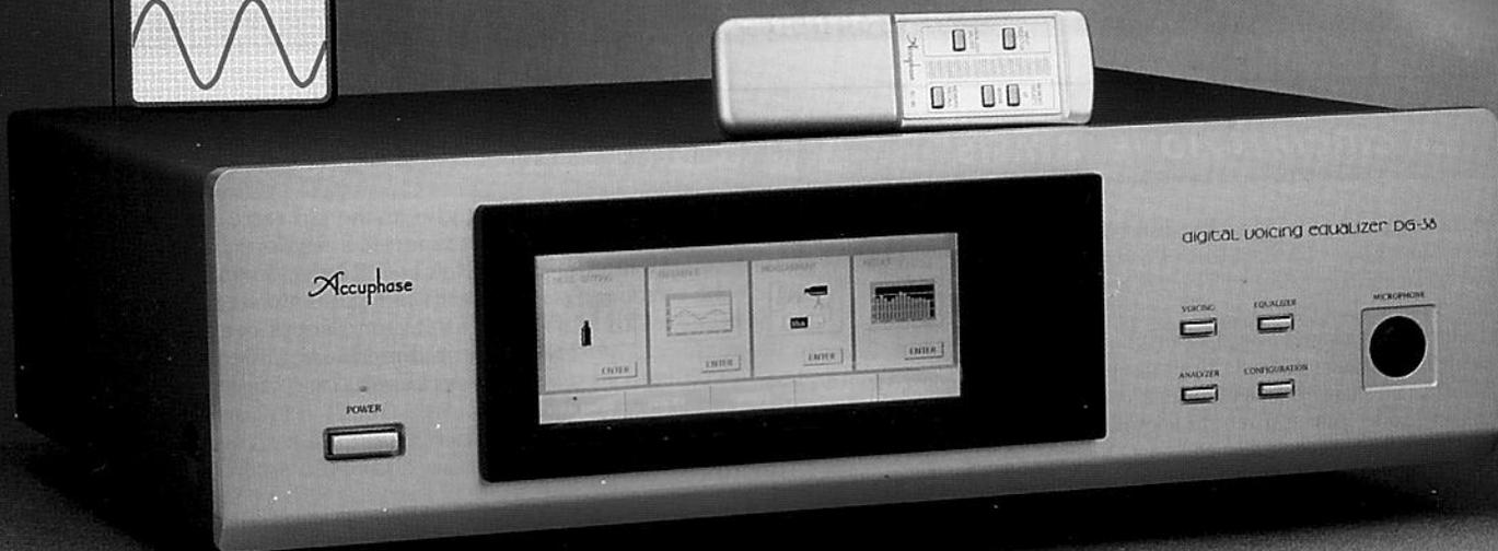
Il telecomando è dotato di pochissimi tasti che consentono l'inserimento ed il disinserimento delle sezioni di equalizzazione, il richiamo delle curve memorizzate e la selezione dell'ingresso.
