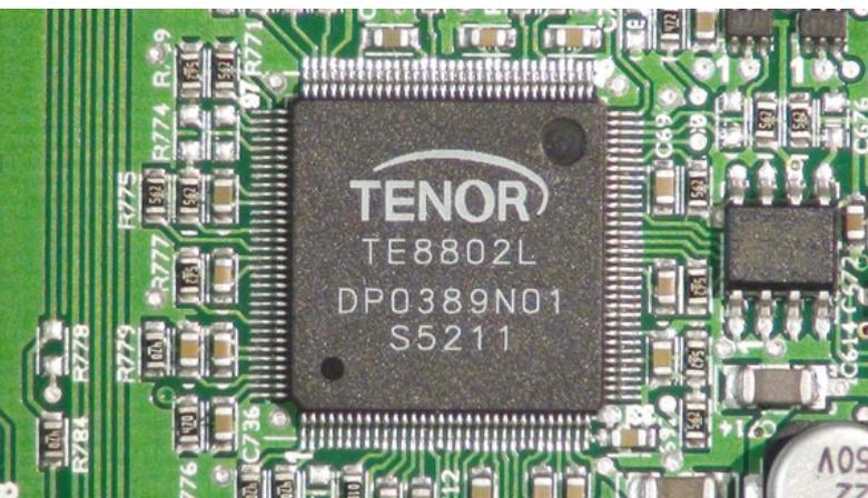
*Il controllore di flusso Tenor TE8802L come appare dopo aver rimosso la piastrina adesiva in rame che ne copre la sigla. Questo componente gestisce la trasmissione asincrona sulla porta USB.*
