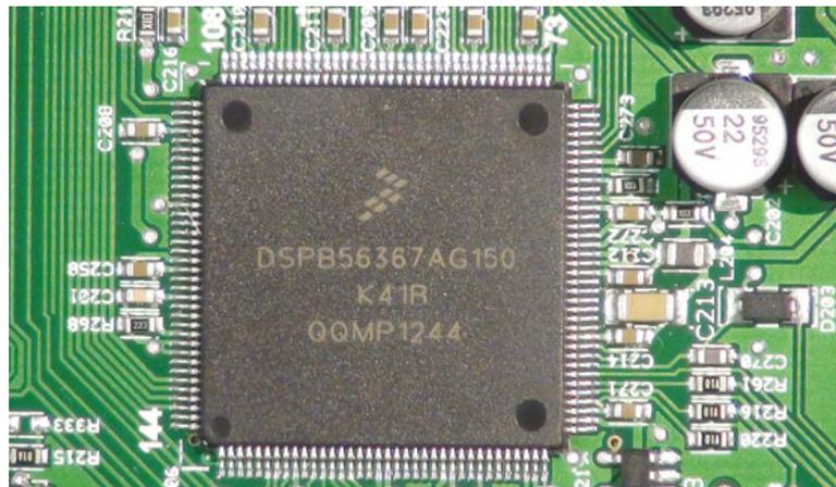
*Ecco il processore audio Freescale che esegue l'interpolazione utilizzando algoritmi basati sull'utilizzo di polinomi di Bezier.*
