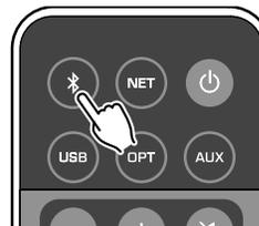
L'indicatore Bluetooth sul pannello anteriore dell'unità lampeggia durante il processo di connessione.
