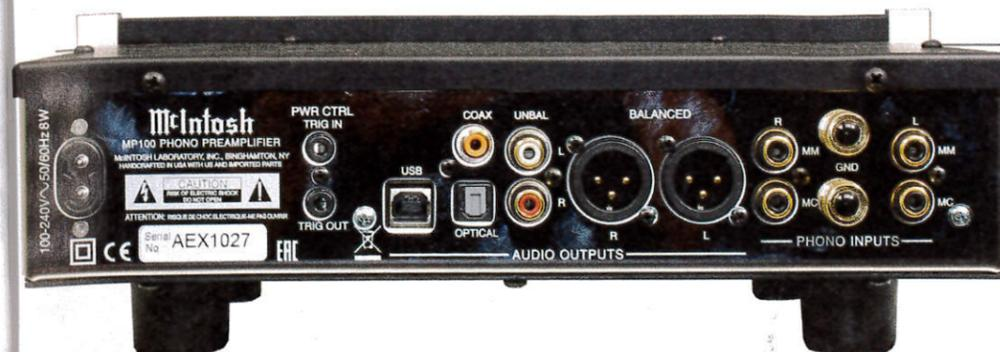
digitale: il McIntosh MP100, infatti, dispone di un convertitore A/D che, una volta trasformato il segnale, lo invia tramite una USB
