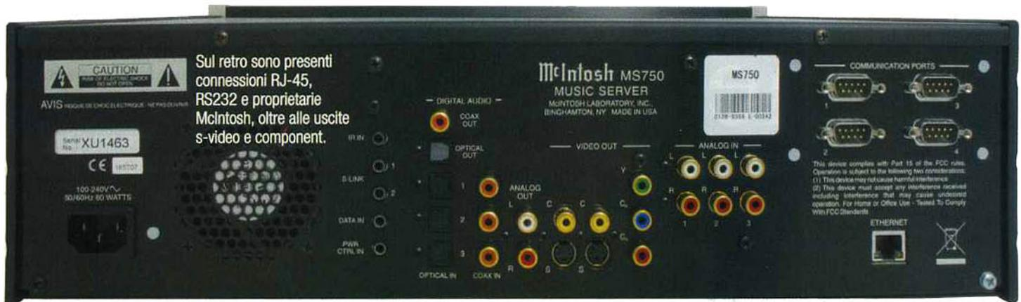
Sul retro sono presenti connessioni RJ-45, RS232 e proprietarie McIntosh, oltre alle uscite s-video e component.
