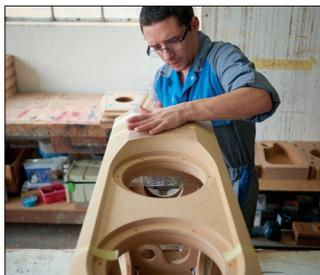
La surface du coffret d'une enceinte est infiniment supérieure à celle des membranes des haut-parleurs, aussi peut-elle rayonner des sons à un niveau proche de celui des membranes, sons qui sont colorés et déformés par les résonances de la structure du coffret. Cela altère la reproduction et brouille l'image sonore.
