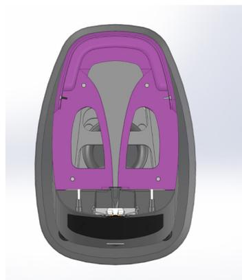
**Fig O** : En rose, la pièce tweeter intermédiaire. De structure monobloc, elle incorpore en son centre un pavillon débouchant sur l'arrière. Un absorbant est placé dans ce pavillon pour obtenir une charge infinie dans un volume restreint. La pièce est ouverte afin d'accroître le volume de charge du grave tout en conservant un volume compact (voir illustration ci-dessous).
