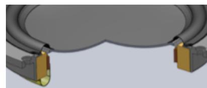
Fig K : Circuit magnétique sans pièces polaires.
