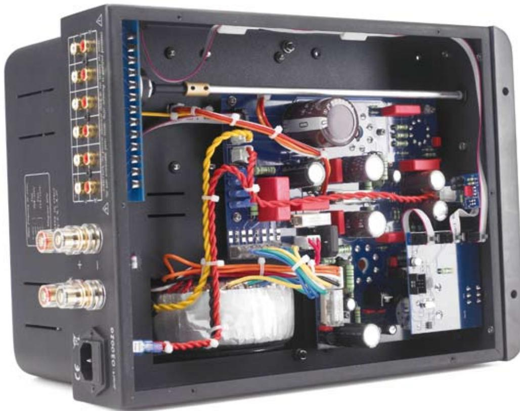
Via Verlängerungsachse agiert der Quellenwahlschalter elektrisch kurz angebunden hinten. Unter der Servo-Platine vorn lugt das Motorpoti heraus. Zwei Elkos (100 und 470 Mikrofard) sowie eine Drossel glätten die Anodenspannung.
